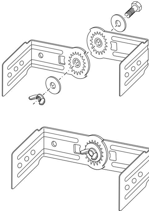
2. Schrauben Sie die Befestigungswinkel mithilfe der Befestigungsschrauben an der Halterung für die Wandmontage fest. Die Halterungen sind beliebig verstellbar. Empfohlen wird ein Abstand von 45 bis 55 cm zueinander.
