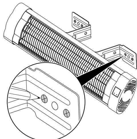
2. Bohren Sie die Löcher an den markierten Stellen in die Wand.
