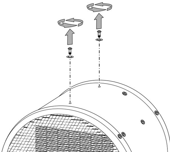
2. Montieren Sie den Transportgriff mit den Schrauben und Unterlegscheiben.
