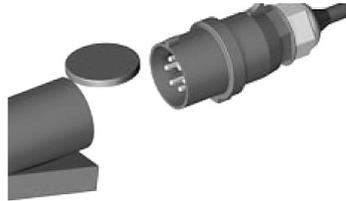
4. Bei längeren Stillstandszeiten ist der Verschlussdeckel des Abgasanschlusses zu schließen.
