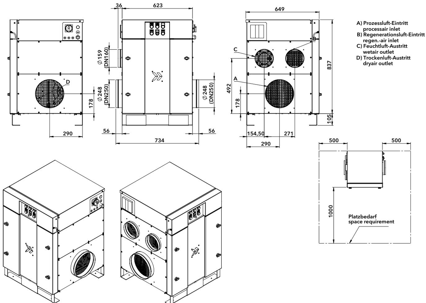
Änderungen vorbehalten. Alle Leistungsdaten beziehen sich auf 1013 mbar, eine Dichte von 1,2 kg/m³ und eine Spannungsversorgung mit 3x400 V/50Hz +PE bzw. 230V/50 Hz. Für ihre Projektauslegung empfehlen wir bzgl. der Entfeuchtungsleistung einen Sicherheitsabschlag je nach Anwendung in Höhe von 10-20 % zu berücksichtigen.
