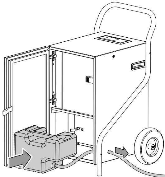
5. Führen Sie das andere Ende des Schlauches zu einem geeigneten Abfluss (z. B. Gully oder einem ausreichend großen Auffangbehälter). Beachten Sie, dass der Schlauch nicht geknickt werden darf.
