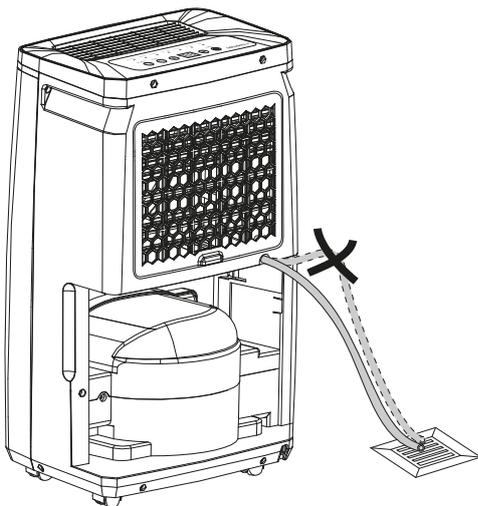
Remover a mangueira se quer recolher o condensado através do tanque de água condensada. Deixar secar a mangueira antes de armazenamento. A mangueira pode ser conectada em qualquer modo operacional para o funcionamento permanente.
