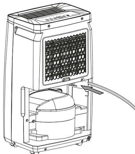
3. Coloque o tanque de água condensada de volta na máquina. Certifique-se de que o tanque de água condensada seja posto corretamente, caso contrário, o aparelho não se liga novamente.
