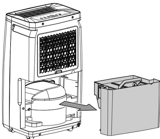
2. Esvazie o tanque de água condensada através de um dreno ou em uma pia.
