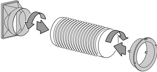
2. Collegare l'estremità adatta del tubo di scarico dell'aria con l'allaccio del tubo flessibile per lo scarico dell'aria (6) posto sul dispositivo.
