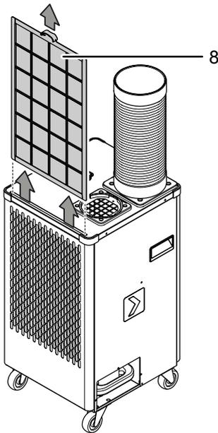
2. Säubern Sie den Filter mit einem weichen, fusselfreien, leicht angefeuchteten Tuch. Sollte der Filter stark verschmutzt sein, säubern Sie ihn mit warmem Wasser, vermischt mit neutralem Reinigungsmittel.
