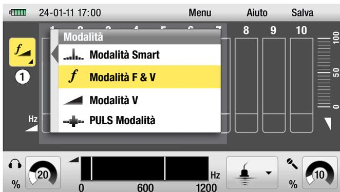
Il simbolo della modalità di misurazione sul display ❶ mostra la modalità impostata. Se la modalità F & V non è stata ancora impostata, andare sul simbolo della modalità di misurazione ❶, attivarlo e confermare la selezione. Si aprirà la finestra di selezione della modalità di misurazione.
