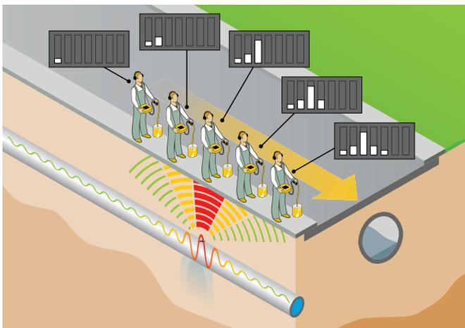
Se l'acqua fuoriesce dalla perdita per un periodo relativamente lungo di tempo, si forma a volte una bolla d'acqua che continua ad essere alimentata dalla perdita. Il suono trasmesso attraverso il terreno è appena udibile e quasi impossibile da rilevare con un microfono a campana.
