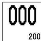
Nell'Area 1 viene ora effettuata una calibrazione dello zero e la concentrazione di idrogeno (200) viene presa come valore di riferimento. Quando si esegue una seconda calibrazione dello zero nell'Area 1, il display digitale mostrerà un valore misurato relativo di 000 e un valore misurato assoluto di 200.
