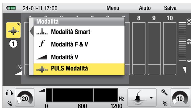
Il simbolo della modalità di misurazione ❶ visualizzato sul display mostra la modalità impostata. Se la modalità PULSE non è stata ancora impostata, andare sul simbolo della modalità di misurazione ❶, attivarlo e confermare la selezione.
