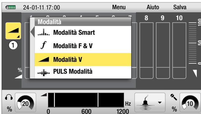
Il simbolo della modalità di misurazione sul display ❶ mostra la modalità impostata. Se la modalità V non è stata ancora impostata, andare sul simbolo della modalità di misurazione ❶ attivarlo e confermare la selezione.
