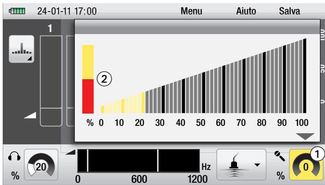
Per impostare la sensibilità del sensore collegato allo strumento di rilevazione delle perdite, accedere nella finestra di visualizzazione al simbolo per l'impostazione della sensibilità del sensore ①, attivare il simbolo e confermare la selezione.
