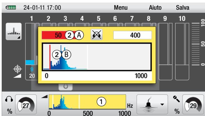
È possibile scambiare in ogni momento tra le singole misure le frequenze preselezionate del filtro con ognuna delle tre modalità di misura della rilevazione acustica delle perdite.
