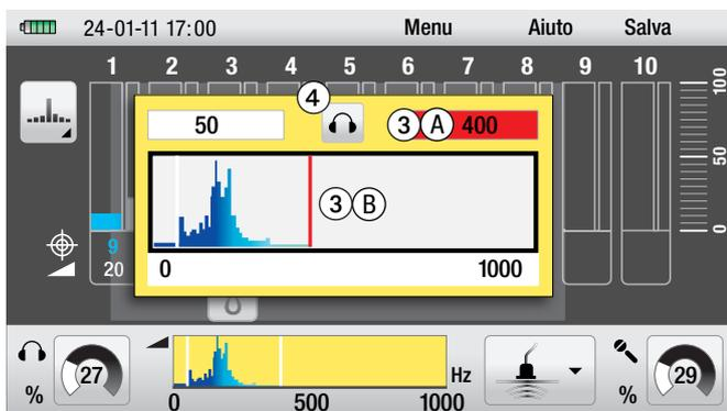
Per modificare il valore di frequenza del filtro passa-basso, premere una volta la rotella di destra. Il filtro passa-basso è adesso attivo. Ciò è indicato dal campo rosso del valore del filtro passa-alto A e la barra ③ del filtro passa-alto ③ B nella banda di frequenza.
