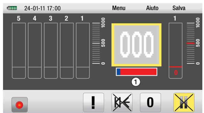
Non appena si seleziona la rilevazione con gas tracciante sul display con il sensore di idrogeno collegato, lo strumento riconosce il sensore e si riscalda fino a raggiungere la temperatura di funzionamento.
