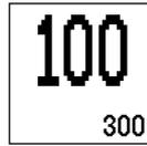
Una nuova misura viene effettuata nell'Area 2. Il display digitale mostra adesso un valore misurato relativo di 100 e un valore misurato assoluto di 300.
