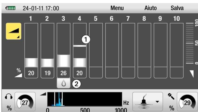
Premere il pulsante di registrazione per avviare la misura. Tenere premuto il pulsante per la durata dell'operazione di misurazione. Lo strumento interromperà la misura quando il pulsante di registrazione non sarà più premuto.
