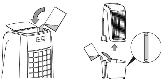
4. Si fuera necesario, introduzca bloques de hielo en el depósito de agua (3) para alcanzar un mayor rendimiento de refrigeración.
