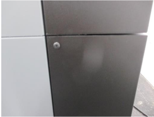
Abbildung 1: Schrauben an den Seiten des TAC V+ lösen
