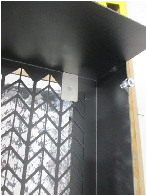
Abbildung 6: Achten Sie auf die korrekte Positionierung der Gewindebolzenbleche
