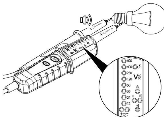
1. Con le due punte del tester (1, 2), toccare i punti di misurazione da controllare della fonte di tensione.
