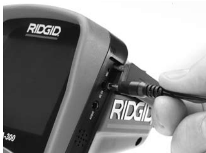
Abbildung 7 - Betreiben des Gerätes mit Netzteil
