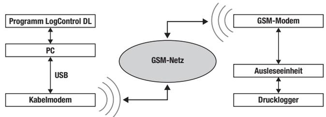
Abbildung 3-5: GSM-Verbindungsschema
