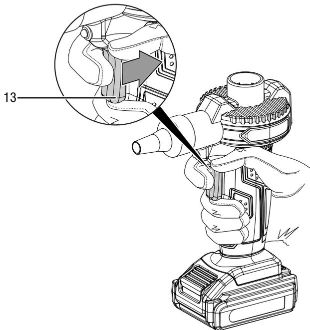
5. Cuando se haya alcanzado el volumen de llenado deseado vuelva a soltar el interruptor de encendido y apagado (13) para apagar el aparato.
