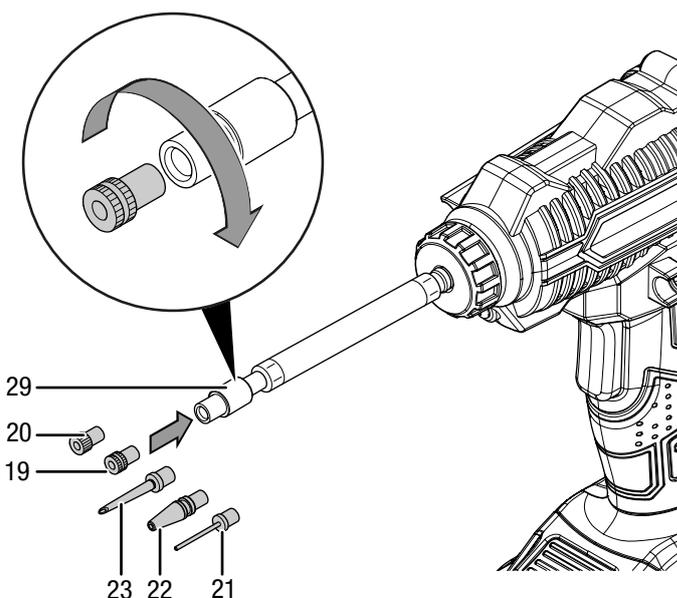
**Cambiar la boquilla (bomba de aire con batería)**
