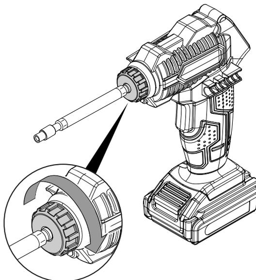
4. Sostenga la manguera de aire comprimido (18) por la toma para el adaptador (29).
