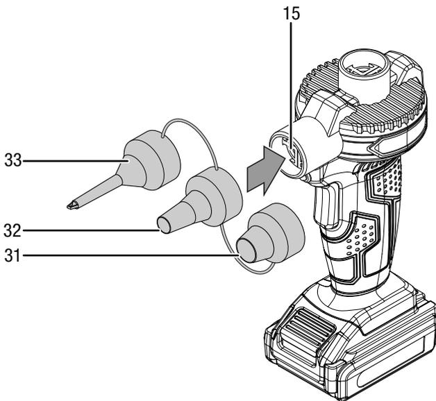
2. Si usted desea deshinchar objetos hinchables coloque la boquilla deseada (31, 32, 33) en la entrada de aire (10).
