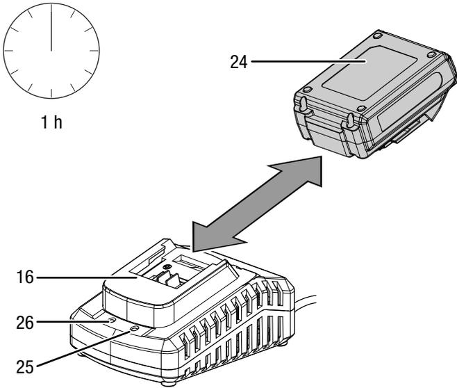
2. Enchufe la clavija de alimentación del cargador rápido (16) en una toma de corriente debidamente protegida.
