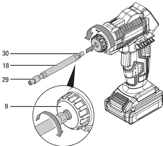
2. Introduzca el lado de conexión (30) de la manguera de aire comprimido (18, opcional) o del adaptador para válvulas (19, 20, 21, 22, 23) girándolo en el sentido de las agujas del reloj.
