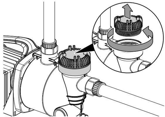
2. Befüllen Sie das Gerät über den Wassereinfüllstutzen (3) bis zum Rand mit dem Fördermedium. Die angeschlossene Saugleitung sollte ebenfalls komplett mit dem Fördermedium gefüllt sein.
