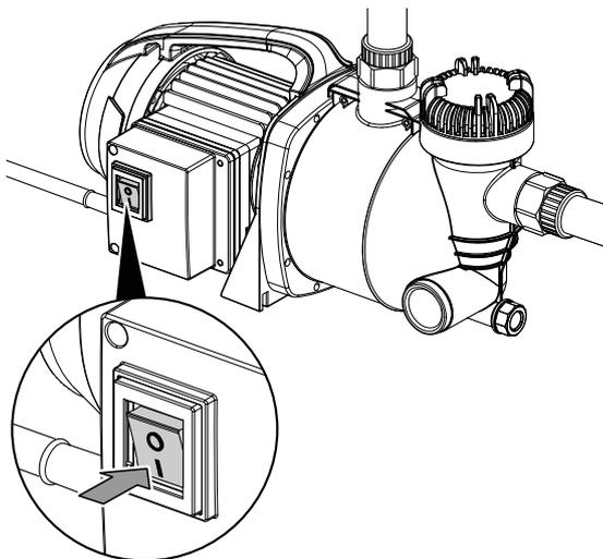
3. Kontrollieren Sie nach dem Einschalten regelmäßig, ob das Gerät ordnungsgemäß arbeitet. Schalten Sie die Stromversorgung ab, wenn sich nach Anlaufen des Motors ein ungewöhnliches Betriebsverhalten zeigt (wie z. B. starke Vibrationen an der Pumpe oder Druckleitung, schwankende Fördermenge o. Ä.). Wenn Sie sich längere Zeit von dem Gerät entfernen, unterbrechen Sie die Stromversorgung des Gerätes.
