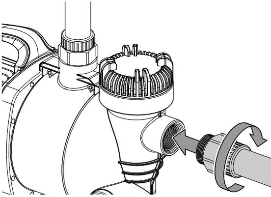
3. Tauchen Sie die Ansaugöffnung der Saugleitung in die Entnahmestelle und achten Sie darauf, dass diese stets ausreichend vom Wasser bedeckt ist.
