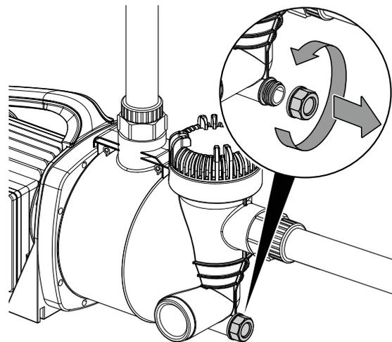
5. Lösen Sie die Druck- und Saugleitung.
