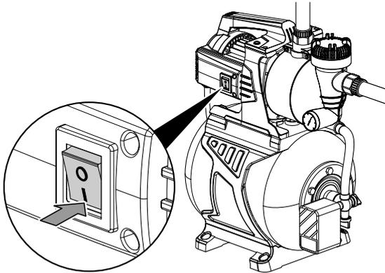
⇒ Das Gerät ist betriebsbereit und schaltet sich ein, wenn durch Druckabfall im System – in aller Regel durch Öffnen eines Verbrauchers an der Druckleitung – der Einschaltdruck von 1,5 bar unterschritten wird.
