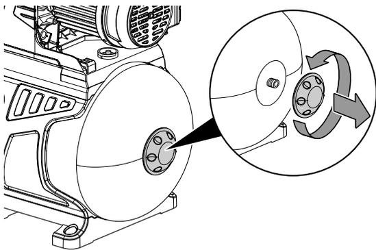
5. Prüfen Sie am Druckkesselventil (8) mit einem Luftdruckmesser den Vorpressdruck. Dieser sollte 1,5 bis 1,8 bar betragen.
