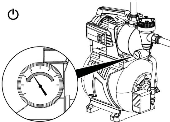
⇒ Das Gerät schaltet sich aus, wenn durch Schließen des Verbrauchers der Druck im System wieder ansteigt und der Abschaltdruck von 3 bar erreicht ist.
