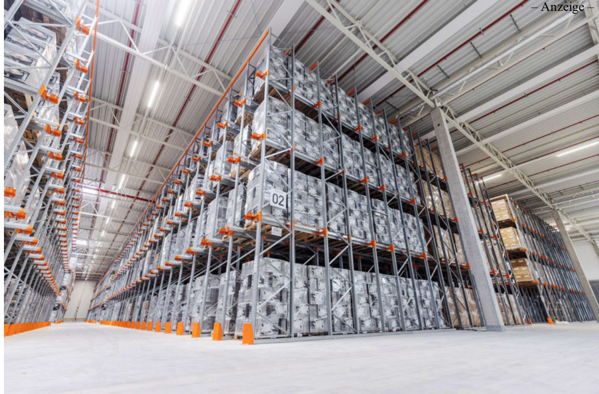
Zwei der Hallen mit insgesamt 20.000 m 2 sind aufwendig auch zur Lagerung von Gefahrstoffen wie Batterien oder Chemikalien ausgestattet. Mit 3 verschiedenen Regalsystemen ausgestattet, können insgesamt 30.000 Paletten eingelagert werden.
